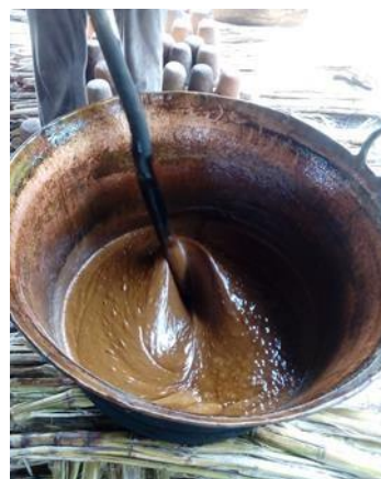
Fig. 2 proceso de enfriamiento antes de vaciar a los moldes. Elaboración propia.
