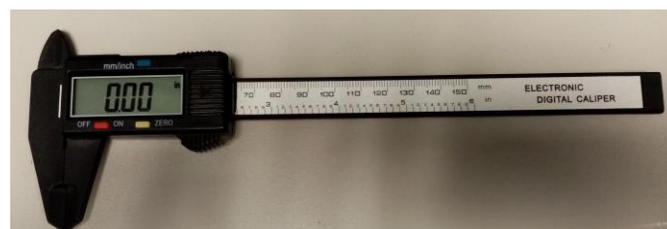
**Fig. 4 Calibrador Pie de Rey utilizado para la medición del portafusibles. Elaboración propia por parte de los autores.**
