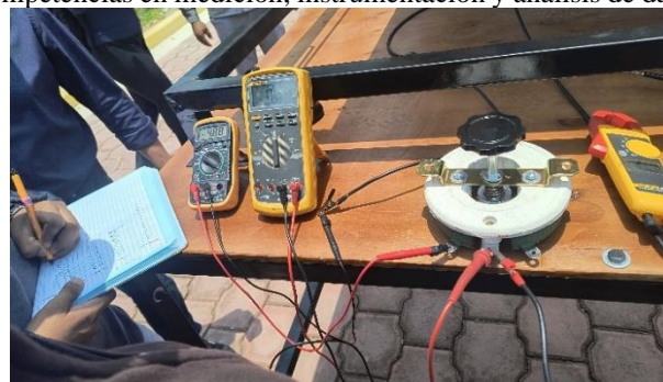
Figura 10 Práctica de obtención de curva característica I-V, P-V. Fuente: propia
