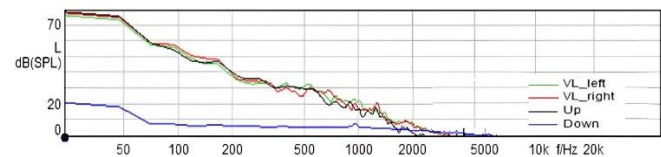
Fig. 10. Medición acústica de magnitud y frecuencia de un automóvil encendido y estacionado.
