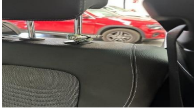
Fig. 4. (a) Posición de micrófono en la cabecera del asiento del conductor, Fig. 4. (b) Posición de micrófono en la cabecera del asiento del copiloto y Fig. 4. (c) Posición de micrófono en la cabecera de los asientos traseros.
