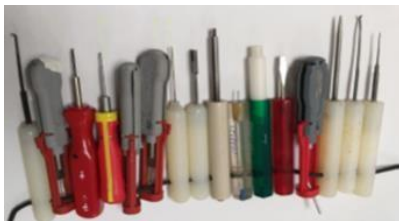
Fig. 3. Picas que se utilizan dependiente del tipo de conector
