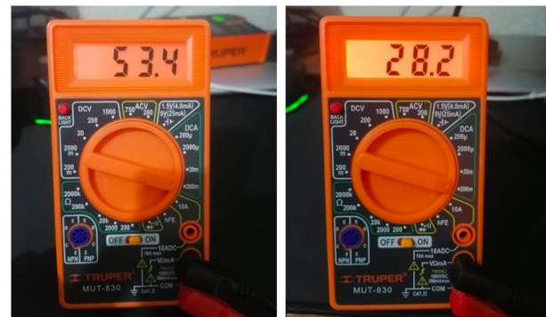
Fig. 10 Medición de corriente en dispositivos maestro y esclavo (Elaboración propia).
